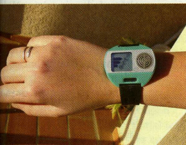
Le capteur miniature alerte les asthmatiques de pollution à l'ozone.
